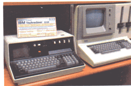
Abb. 2. Mobiler Tischcomputer „IBM-5110“ mit 2-MHz-Prozessor von 1978 (links), daneben späteres Modell mit größerem Bildschirm. [Photos S. Brodka]
